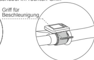
Drücken Sie mit dem rechten Daumen auf die Beschleunigungstaste; die Motorgeschwindigkeit erhöht sich. Lassen Sie die Taste los, um die Geschwindigkeit bis auf Null zu reduzieren.
